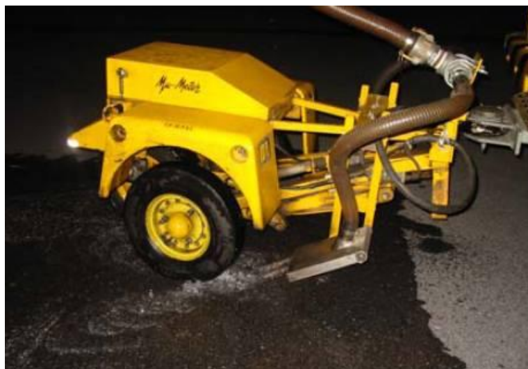
Foto 16: Sistema espargidor de água (fonte: RODRIGUES FILHO, 2006)
