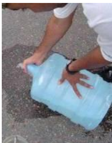
Foto 19: Superfície a ser ensaiada molhada até saturação
