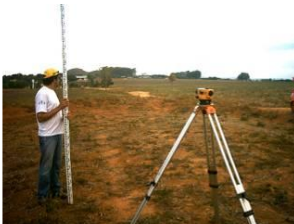
Foto 22: Processo de medição de nível e mira (fonte: www.cnpab.embrapa.br/publicacoes )
